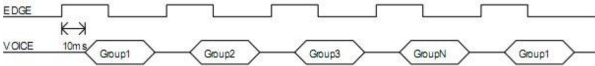
此触发方式仅限于在 OKY 端口。收到正脉冲信号后开始播放第一段地址语音，再次收到正脉冲信号则播放第二段地址语音，依次发到最后一段后，再次触发则重新开始播放第一段语音，如此循环。
