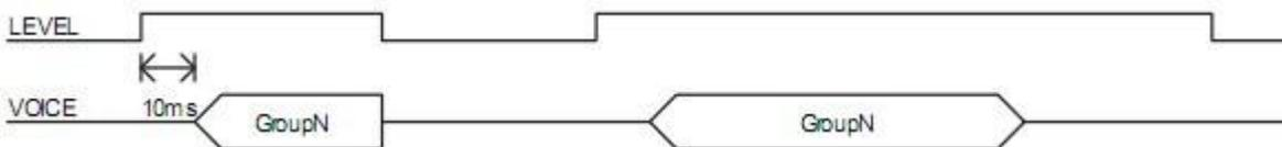
收到高电平后播放语音，高电平信号停止时，语音也停止播放。即时一直保持高电平信号，在语音播放完毕后也不再有任何动作。
