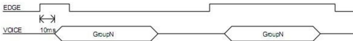
收到正脉冲信号后开始播放语音，正脉冲信号停止后语音继续播放完毕，如果正脉冲信号一直保持，并且持续的时间超出语音播放的长度，则播放完语音即停止，不再继续播放语音。
