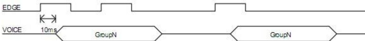
收到正脉冲信号后开始播放语音，在语音结束前如果再次收到正脉冲信号，则没有动作产生，在语音播放结束后再次收到正脉冲信号才会重新播放语音。
