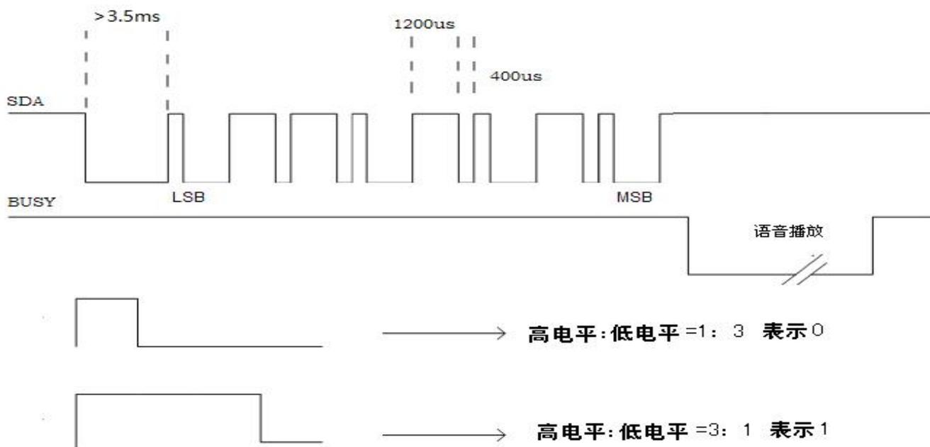
SDA 发送 3.5ms-8ms 低电平再发送高低电平 3:1 或 1:3 信号且数据低位先送。时序范围为 400us: 1200us 到 800us: 2400us。发完后将 SDA 上拉 >200us 再发下个数据。
