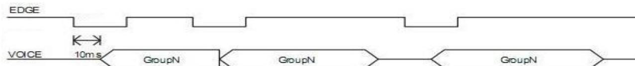
收到脉冲信号后开始播放语音，在语音结束前如果再次收到脉冲信号，则没有动作产生，在语音播放结束后再次收到脉冲信号才会重新播放语音。
