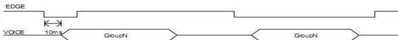
收到脉冲信号后开始播放语音，在语音结束前如果还收到第二次正脉冲信号，则重新开始播放语音，在语音播放的过程中无收到脉冲信号则播放完整段语音。
