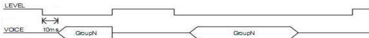
收到电平信号后播放语音，电平信号停止时，语音也停止播放，。即一直保持电平信号，在语音播放完毕后也不再有任何动作。
