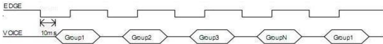
收到脉冲信号后开始播放第一段地址语音，再次收到脉冲信号则播放第二段地址语音，依次发到最后一段后，再次触发则重新开始播放第一段语音，如此循环。
