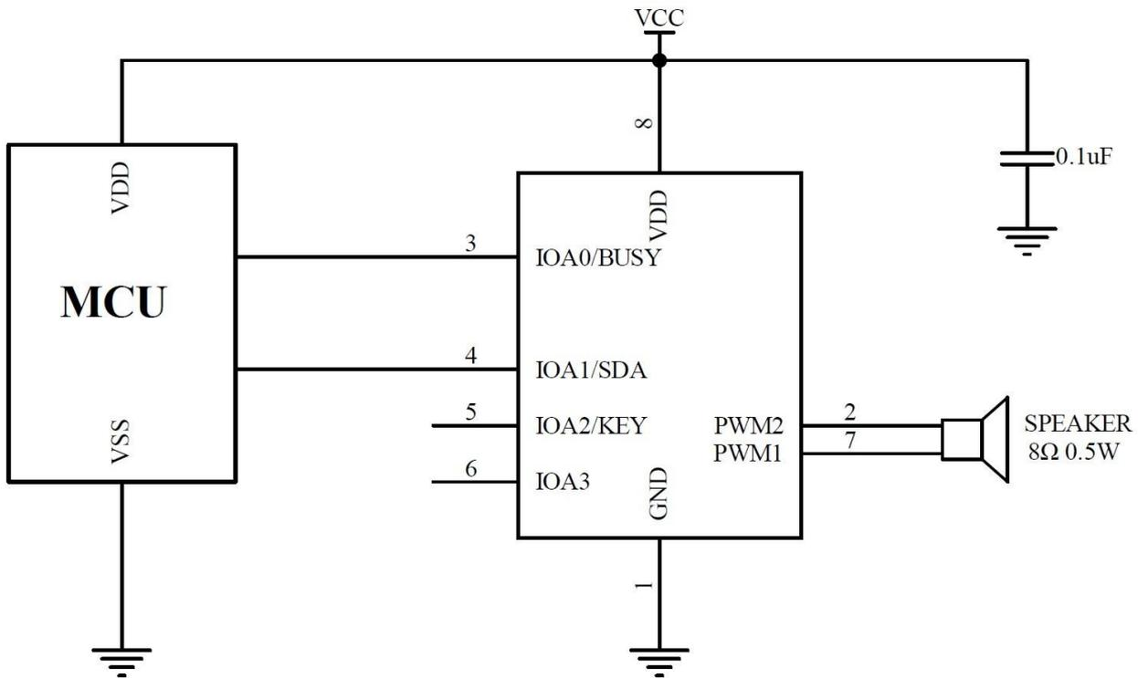
注:MCU 和语音芯片电压不相同时,控制线需串 330 欧的限流电阻或二极管做隔离.
