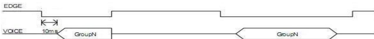
收到脉冲信号后开始播放语音，脉冲信号停止后语音继续播放完毕，如果脉冲信号一直保持，并且持续的时间超出语音播放的长度，则播放完语音即停止，不再继续播放语音。
